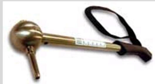
**Figure 5 :** Le marteau sondeur.
